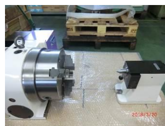
NC制御インデックステーブルで丸物加工を効率化しています
